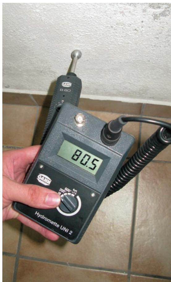
Feuchtigkeitsmessung an der Wandoberfläche
