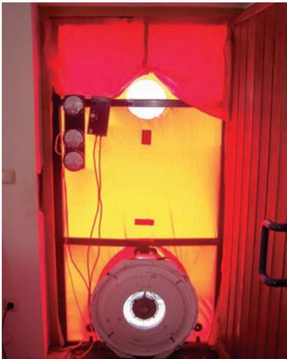
Luftdichtheitsprüfung mit Gebläse an der Haustür
