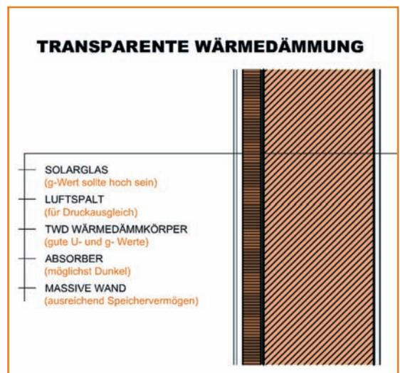
Aufbau der transparenten Wärmedämmung
