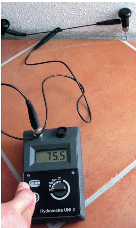
Feuchtigkeitsmessung in der Beschüttung mittels Sonden
