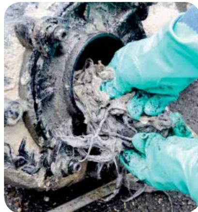
Da sich Feuchttücher im Wasser nicht auflösen oder zersetzen, verstopfen sie Toiletten, Abflussrohre und sogar ganze Kanalstränge. Denn Feuchttücher wickeln sich um die Laufräder der Pumpen und führen so zum Pumpenversagen.
